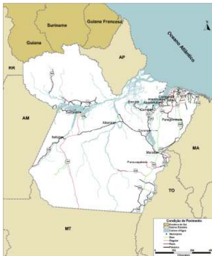
Figura 6.6: Condição de Pavimento na Rede Rodoviária 2015 – Cenário A a – todo o Estado b – destaque Belém e nordeste PA
