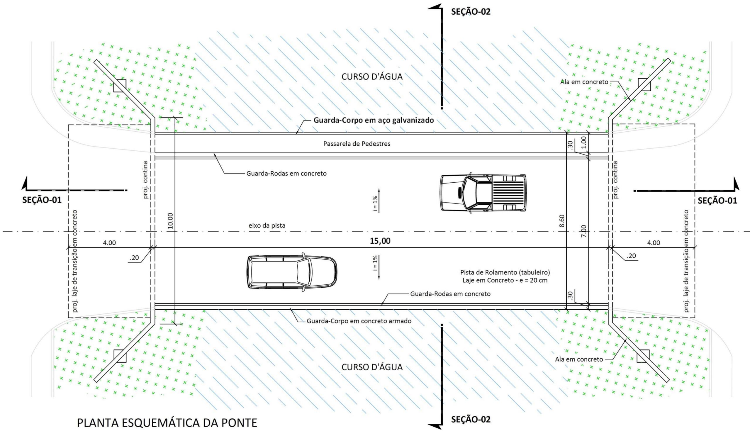
PLANTA ESQUEMÁTICA DA PONTE
