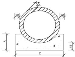
onde:  $e=8,5\text{cm}$ ;  $A=0,35\text{m}$ ;  $C=1,77\text{m}$ ;  $D_{\text{externo do tubo}}=1,22\text{m}$
