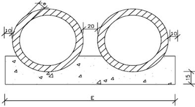
onde:  $e=11,00\text{cm}$ ;  $A=0,40\text{m}$ ;  $E=3,74\text{m}$ ;  $D_{\text{externo do tubo}}=1,22\text{m}$
