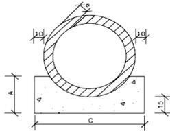
onde:  $e=8,5\text{cm}$ ;  $A=0,35\text{m}$ ;  $C=1,77\text{m}$ ;  $D_{\text{externo do tubo}}=0,97\text{m}$
