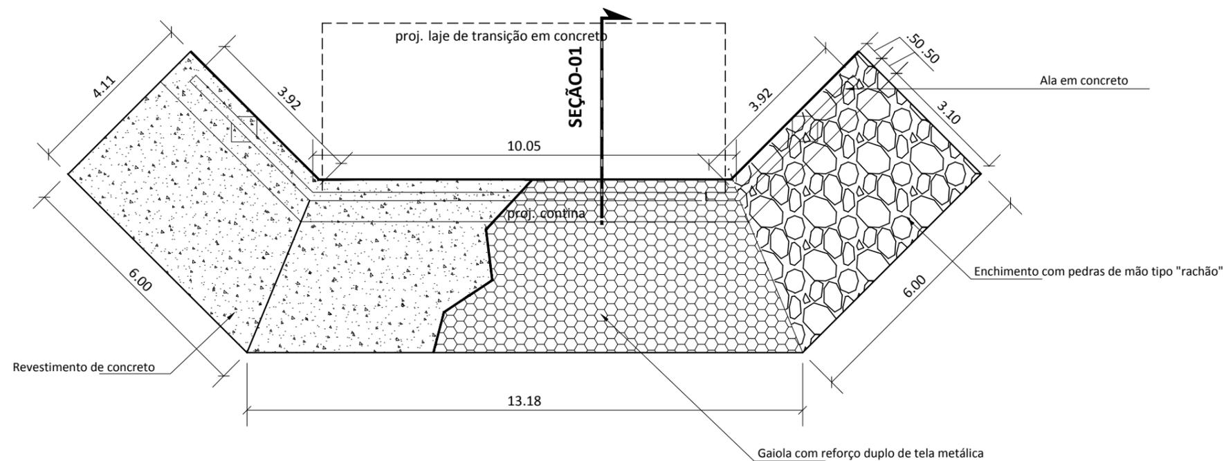
**PLANTA BAIXA ESQUEMÁTICA DE IMPLANTAÇÃO DO GABIÃO**
