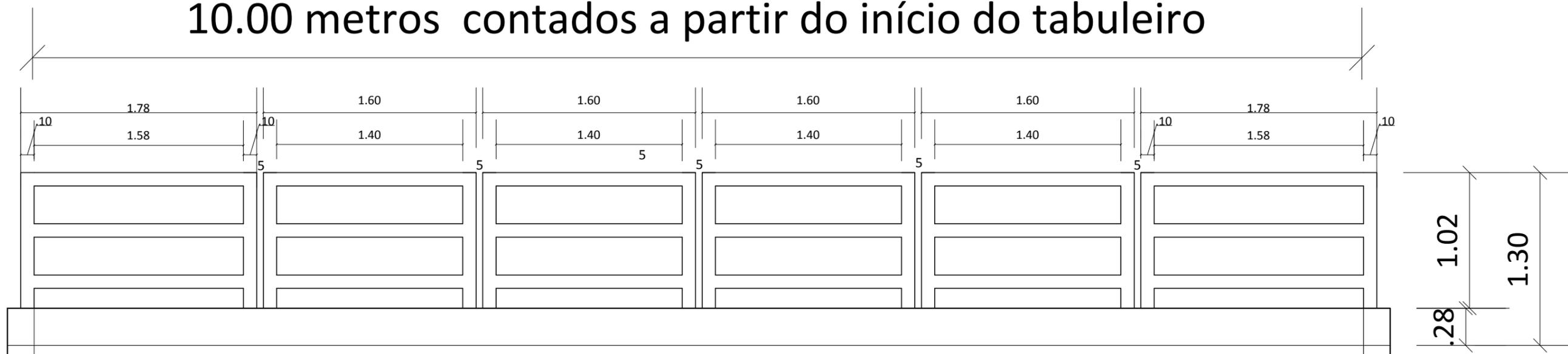
DETALHAMENTO DO GUARDA-CORPO MODULADO DE CONCRETO
