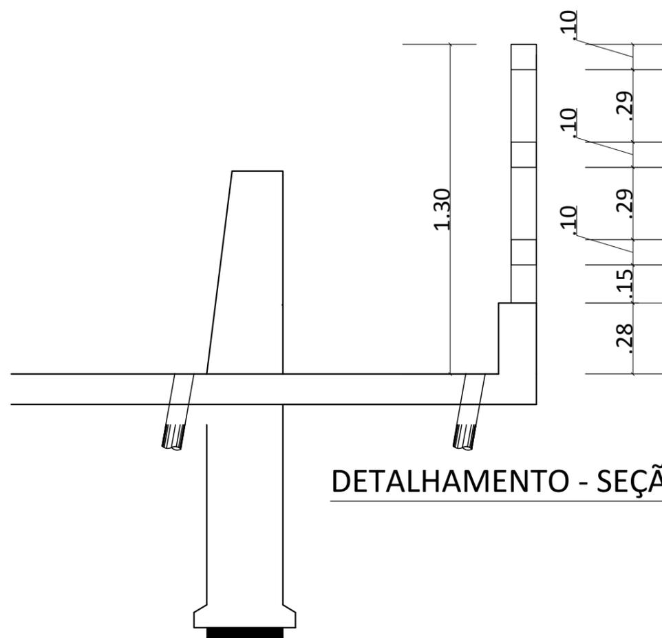
DETALHAMENTO - SEÇÃO DO GUARDA-CORPO
