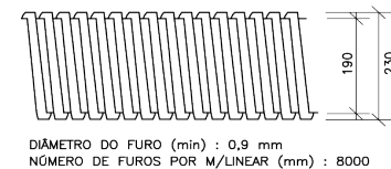
DETALHES DE TUBO DRENO CORRUGADO PEAD
