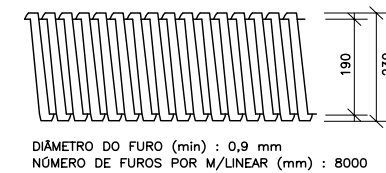
DETALHES DE TUBO DRENO CORRUGADO PEAD
