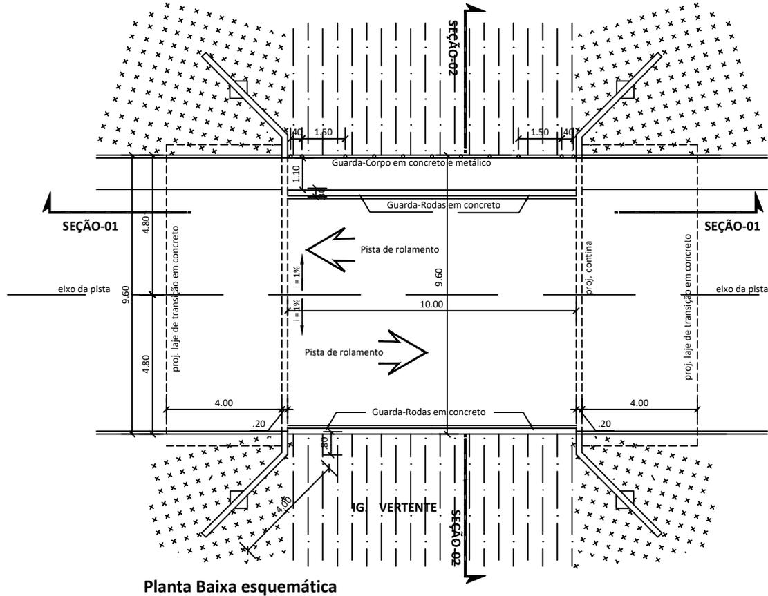
Planta Baixa esquemática
