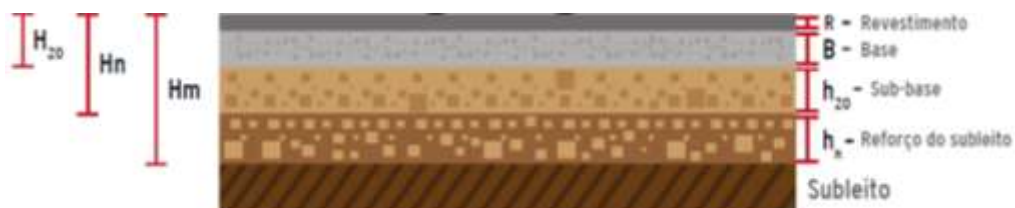
Figura 27 – Simbologia das camadas do pavimento DNIT, 2006.
